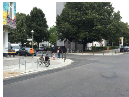
Gehwegvorstreckungen mit Fahrradbügeln an der Markthalle IX
